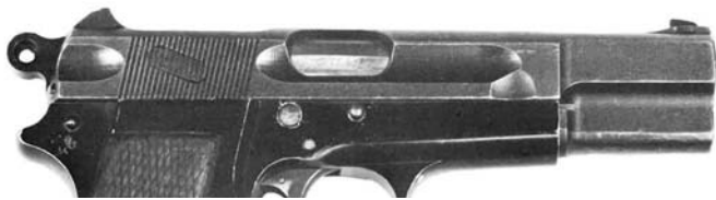
Детаљ олакшаног пиштоља HP са усадником од лаке легуре, израђеног у „Џону Инглису“ – подужни конкавни урези на навлаци
